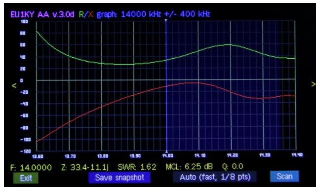
Еще одно нажатие на **ЦЕНТР** экрана - произойдет смена на график параметра S11 (в меню настроек – Configuration возможно отключить/включить показывать или не показывать этот график)
